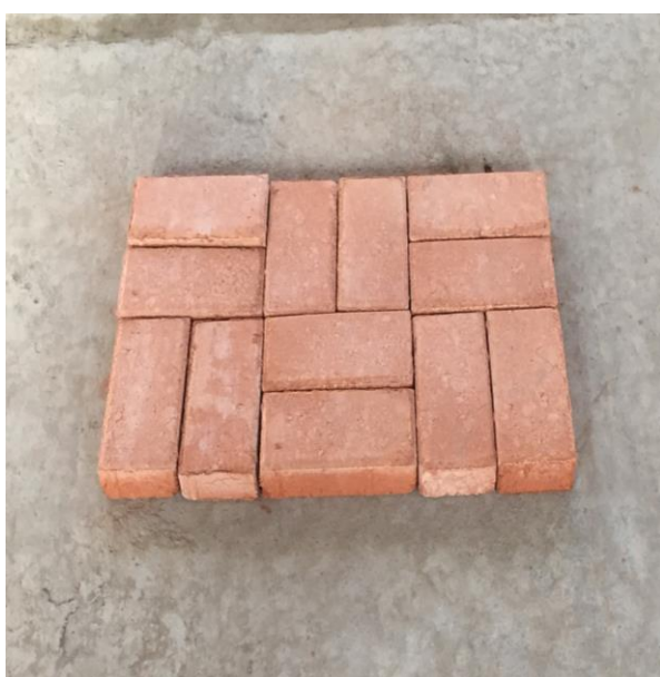
Сурет 39 - Дірілді престоумен қалыптанған күйдірілген керамикалық төсемдердің жалпы көрінісі
