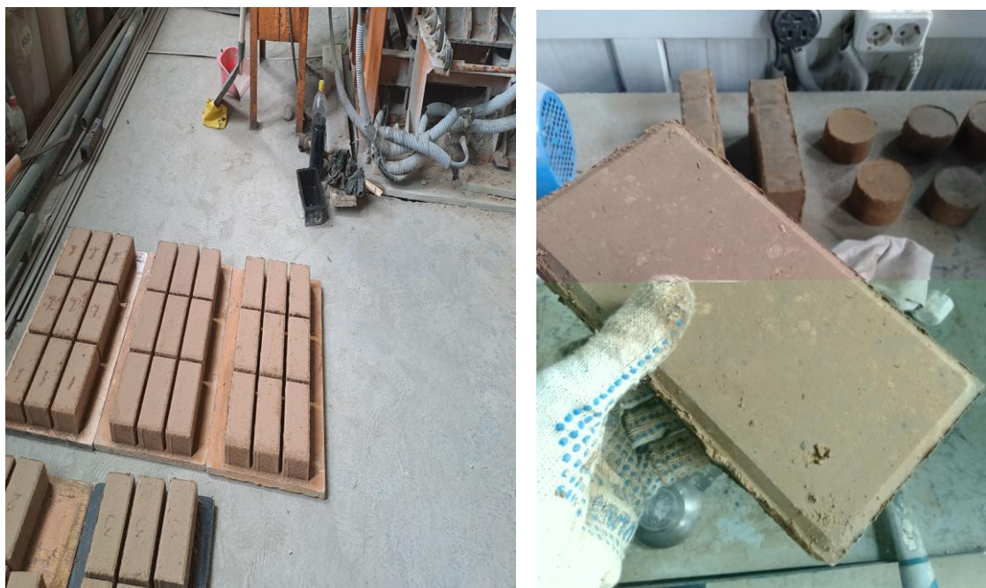
Сурет 37 – Дірілді престоу әдісімен қалыптанған қам керамикалық төсемдер
