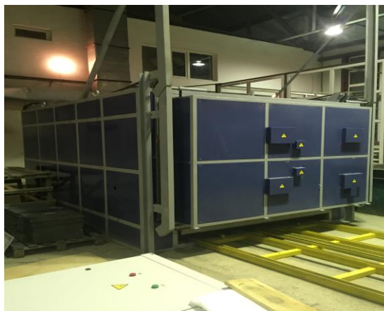
Сурет 38 - Жылжымалы паллетті СИКРОН П-2000х3000х1500, t-1150 РЭ маркалы камералы кедергілі пеш
