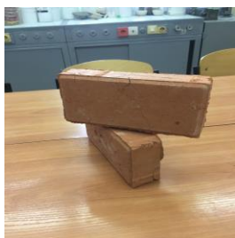
Сурет 26 - Саз-талық жынысы шикізат композицияларының негізінде керамикалық төсемдердің үлгілері
