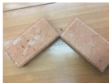
Сурет 26 - Саз-талық жынысы шикізат композицияларының негізінде керамикалық төсемдердің үлгілері
