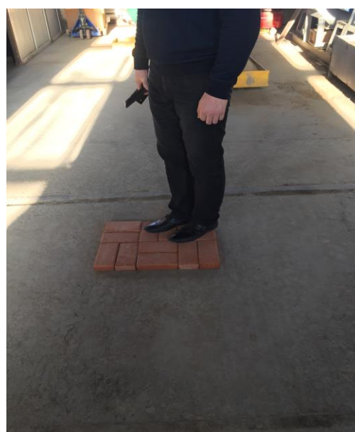
Сурет 39 - Дірілді престоумен қалыптанған күйдірілген керамикалық төсемдердің жалпы көрінісі
