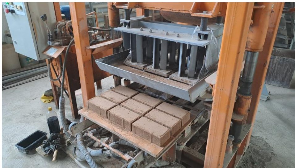
Сурет 32 - «Мастек-Метеор» қалыптау кешенінде қалыпталған қам керамикалық төсемдердің жалпы көрінісі
