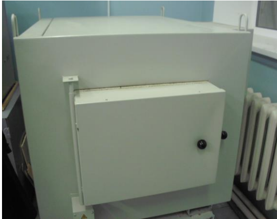
Сурет 33 – Керамикалық төсемдерді электрлі муфельді пеште күйдіру фрагменттері
